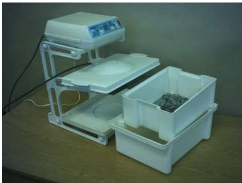
Рис. 3. Общий вид установки УЗО, на базе 5-ти литрового контейнера ЕДПО.
